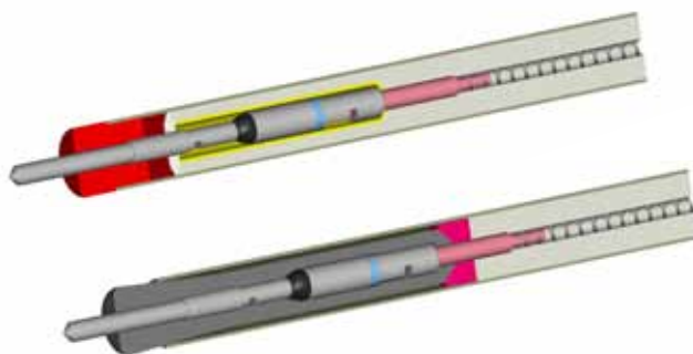
Rörelement med monterad smältsäkring.
